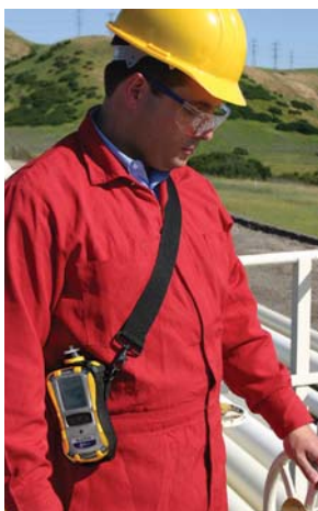
MultiRAE utilizado para a monitorização da exposição dos trabalhadores numa refinaria de petróleo
