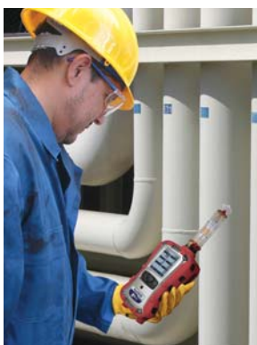
MultiRAE Benzene usado para detecção de vazamento
