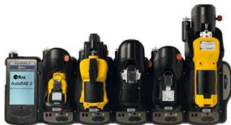
Sistema AutoRAE 2 configurado com controlador e cinco base para portáteis ToxiRAE Pro, MultiRAE (com bomba), QRAE 3, MicroRAE e monitores Handheld PID
